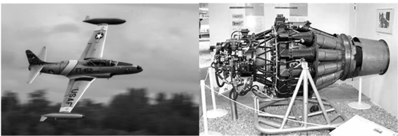
图 2 T-33 教练机和艾利逊 J33-A-35 发动机 Fig.2 T-33 trainer and Allison J33-A-35 engine
